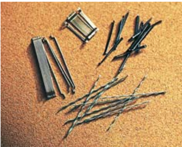
Exemples de fibres métalliques.
