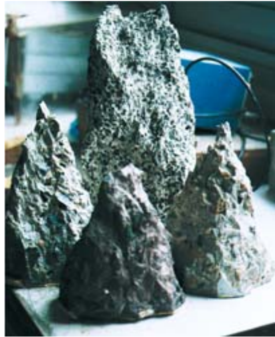
Éprouvettes après essai de rupture en compression.
