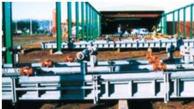
Vibreur de coffrage : l'appareil et son utilisation sur chantier in situ.
