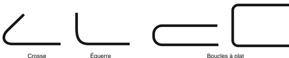
**Figure n° 35: exemples d'ancrages par courbure.**
