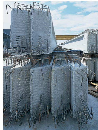
Les poutres sont transférées et stockées sur le parc de l'usine, en appui sur des madriers.
