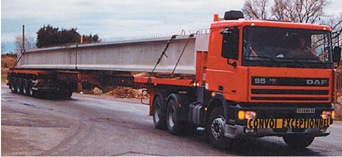
Transport de poutres par camion.
