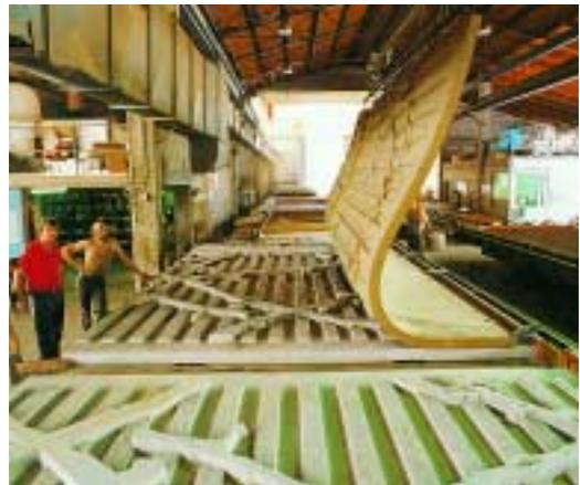
Réalisation de reliefs complexes obtenus à l'aide d'une matrice en élastomère.
